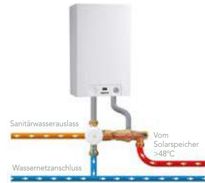
Wassertemperatur aus Speicher größer 48°C
